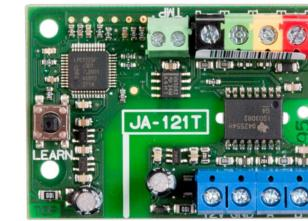
Module cho phép truyền 2 chiều tín hiệu có dây của JABLOTRON 100+ đến một dòng nối tiếp RS-485 của hệ thống khác
